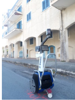
Fase di misura dei punti di appoggio - TIMMS in fase di misura GCP
